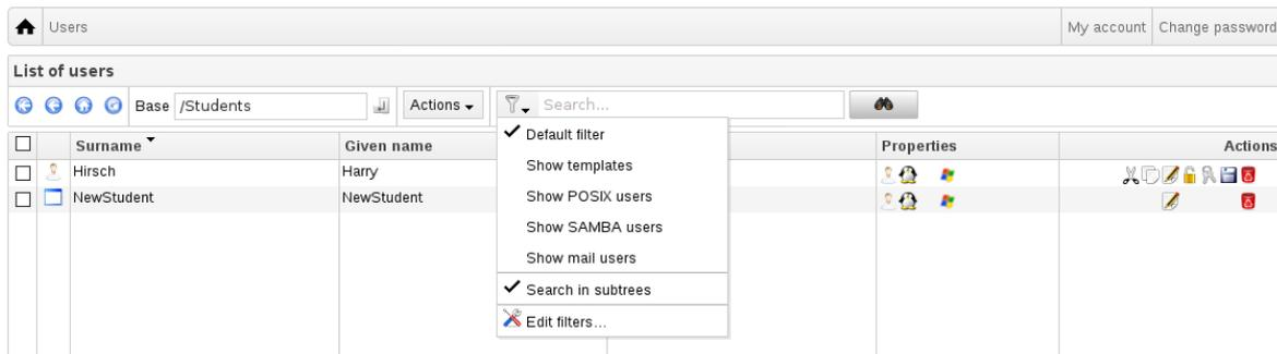
Per modificare o cancellare un utente si usa Gosa<sup>2</sup> per sfogliare l'elenco degli utenti nel proprio sistema. In alto a sinistra dello schermo, si trova il riquadro Filter, uno strumento di ricerca fornito da Gosa<sup>2</sup>. Se non si conosce esattamente dove si trova l'account nell'albero, occorre spostarsi nel livello di base dell'albero di Gosa<sup>2</sup>/LDAP e cercare con l'opzione chiamata: [x] Cerca in subtrees.
